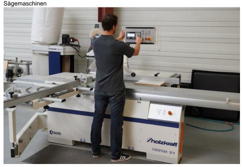
Das schwenkbare Panel gewährleistet jederzeit die bequeme Bedienung der Formatkreissäge (Bild: Stürmer Maschinen).
