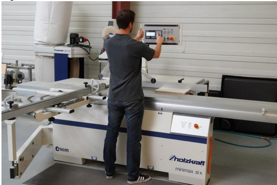
Das schwenkbare Panel gewährleistet jederzeit die bequeme Bedienung der Formatkreissäge (Bild: Stürmer Maschinen).
