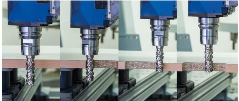
Ein klassischer Einsatz für den neuen Rechts-/Linkslauffräser ist eine Einsatzfräsung (Bild: Leuco Ledermann).
