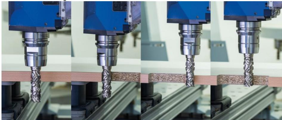
Ein klassischer Einsatz für den neuen Rechts-/Linkslauffräser ist eine Einsatzfräseung
