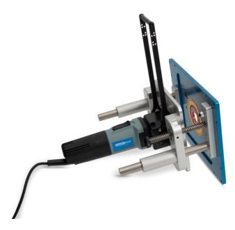
Der Fräsmotor mit Schnellspannsystem erlaubt den Wechsel eines Schaftfräsers ohne zusätzliches Werkzeug (Bild: Sauter).
