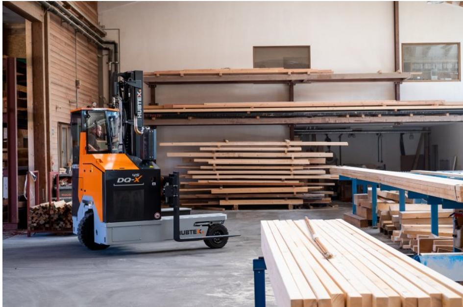
Der Vierwege-Seitenstapler eignet sich besonders für den sicheren Transport von langen und sperrigen Lasten (Bild: Hubtex Maschinenbau).
