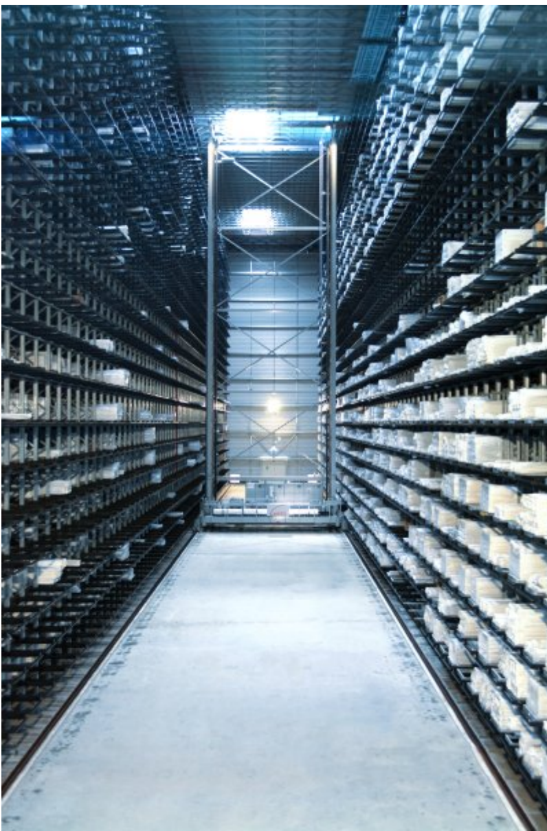
Das 90 m lange und 25 m hohe, vollautomatische Hochregallager mit vier parallel angeordneten Regalblöcken (Bild: Kasto Maschinenbau).
