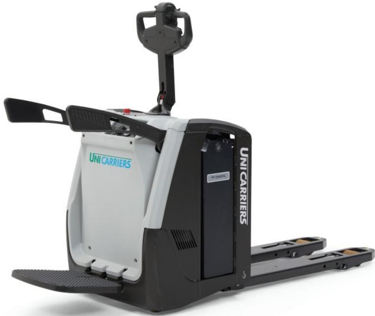
Dieser Niederhubwagen verfügt über eine klappbare Plattform, die sich besonders für Laderampen eignet (Bild: Logisnext Germany).
