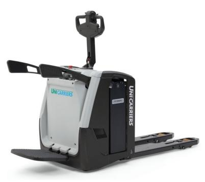
Dieser Niederhubwagen verfügt über eine klappbare Plattform, die sich besonders für Laderampen eignet (Bild: Logisnext Germany).
