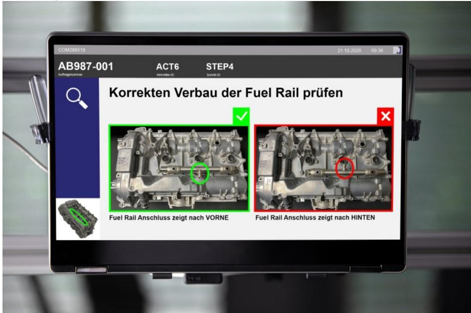
Die virtuelle Grenzmustertafel ermöglicht eine visuelle Inline-Prüfung direkt nach dem Montageprozess (Bild: DE software & control).
