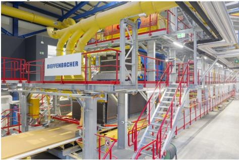
Dank Modernisierung der Formstation einer Spanplattenanlage wird die Oberflächenqualität verbessert (Bild: Dieffenbacher).
