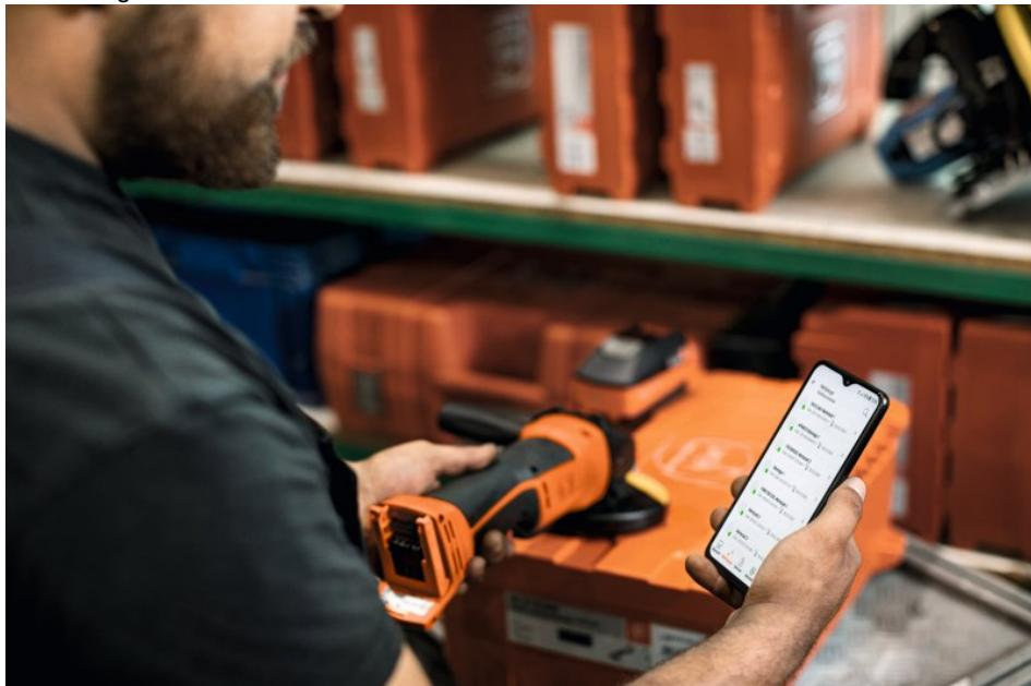
Die Registrierung der Werkzeuge in der Werkzeugverwaltung erfolgt einfach über einen Scan des Typenschildes (Bild: C. & E. Fein).
