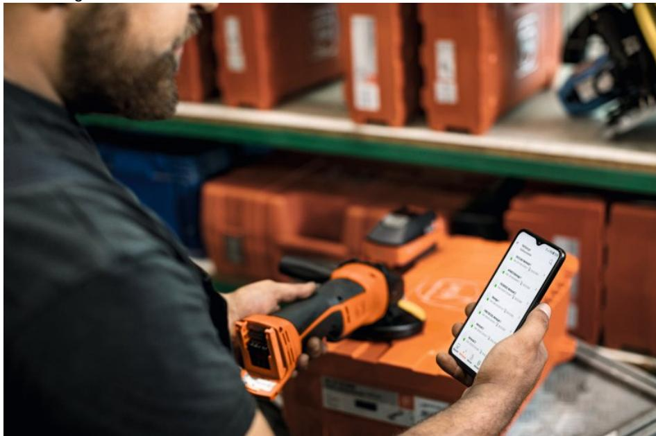
Die Registrierung der Werkzeuge in der Werkzeugverwaltung erfolgt einfach über einen Scan des Typenschilds (Bild: C. & E. Fein).
