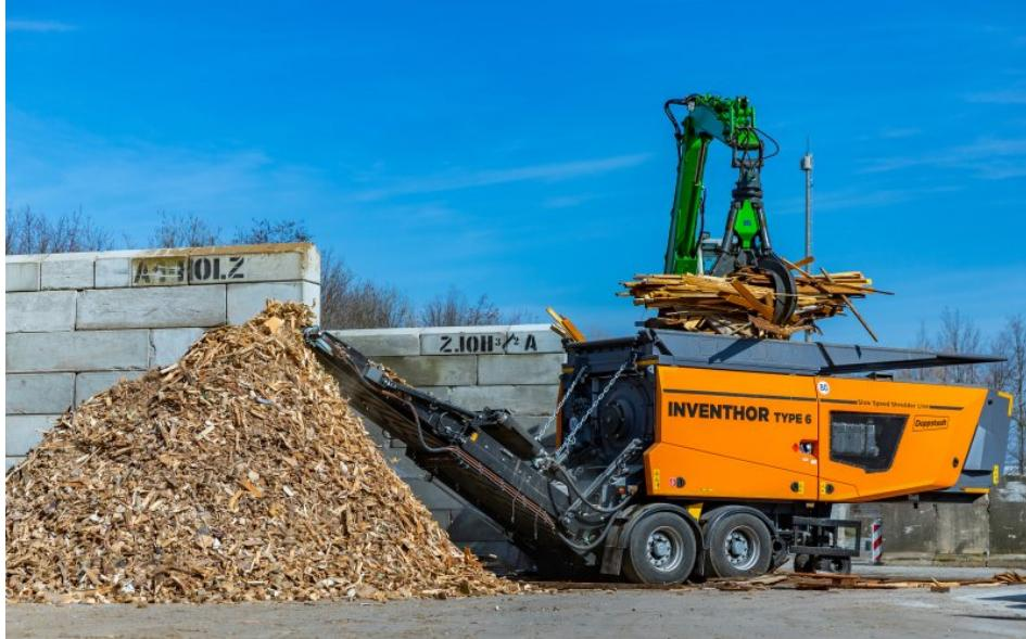
Durch Wechsel des Zerkleinerungspakets kann der Zerkleinerer schnell auf neue Materialien eingestellt werden (Bild: Doppstadt Umwelttechnik).
