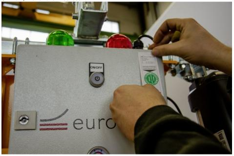
Das Anbringen der Sicherheitsplakette dokumentiert, dass die Arbeitsmittel ordnungsgemäß gemäß UVV funktionieren (Bild: Eurotech).
