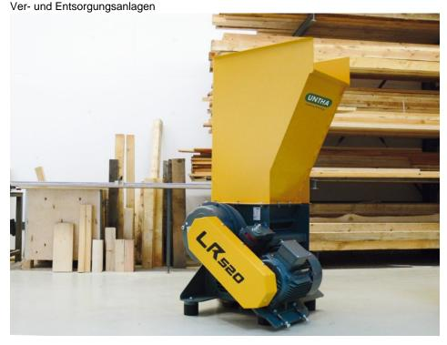
Der kompakte Restholzzerkleinerer benötigt lediglich einen Quadratmeter Stellfläche (Bild: Untha shredding technology).
