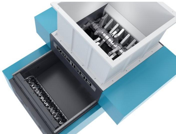
Der Rotor des Vorzerkleinerers (o.) bricht das Material vor, bevor es die Schneidkronen des Schredders zerkleinern (Bild: Vecoplan).
