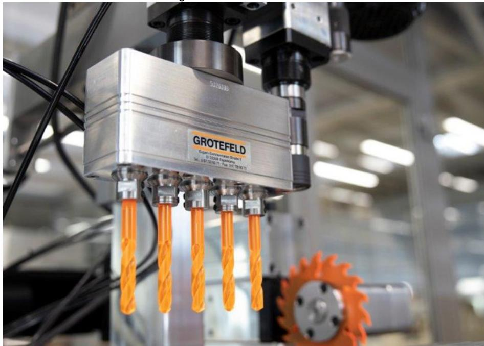
Mehrspindelgetriebe auf Bohreinheit »B050« (Bild: Grotefeld).
