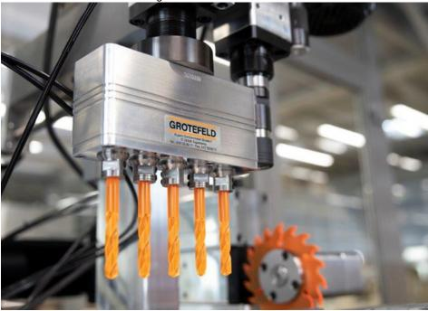
Mehrspindelgetriebe auf Bohreinheit »B050« (Bild: Grotefeld).
