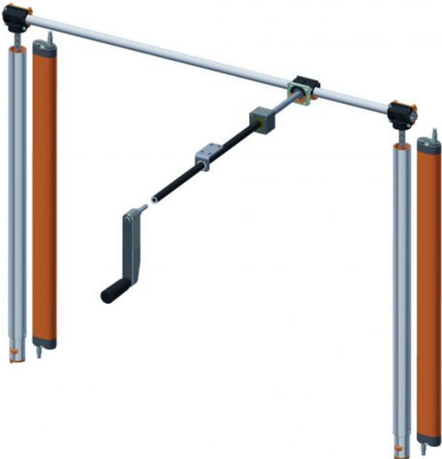
Das neue, rein mechanische Kurbel-Hubsystem »Ket-Twist 660-3053« von Ketterer ermöglicht einen maximalen Hub von 660 mm. Der Tisch lässt sich sehr schnell verstellen, denn pro Kurbelumdrehung werden 40 mm Höhenunterschied realisiert. So ist mit nur wenigen Umdrehungen schnell und komfortabel jede beliebige Tischhöhe zwischen 590 und 1250 mm einstellbar. Das neue Kurbel-Hubsystem erfüllt damit die
