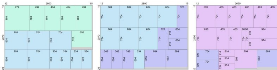
Software optimiert den Plattenzuschnitt (Grafik: Fraunhofer SCAI).
