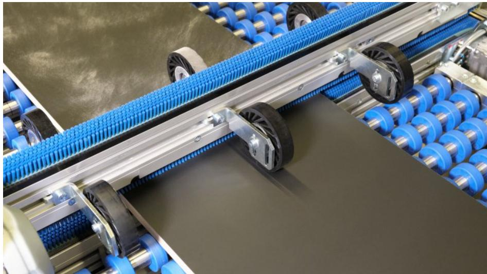
Mit den Kombi-Schwertbürsten wird selbst feinster Staub von der Oberfläche entfernt
