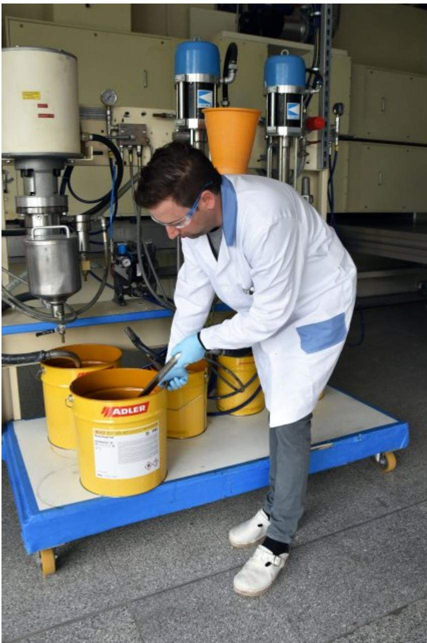
Durch die gelartige Konsistenz entfaltet das Reinigungssystem seine hohe Reinigungswirkung in Lackleitungen (Bild: Adler).
