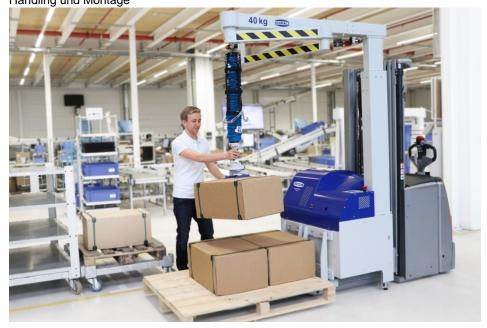
Der ergonomische Vakuum-Schlauchheber kommt per Flurförderzeug dahin, wo er gebraucht wird (Bild: J. Schmalz GmbH).
