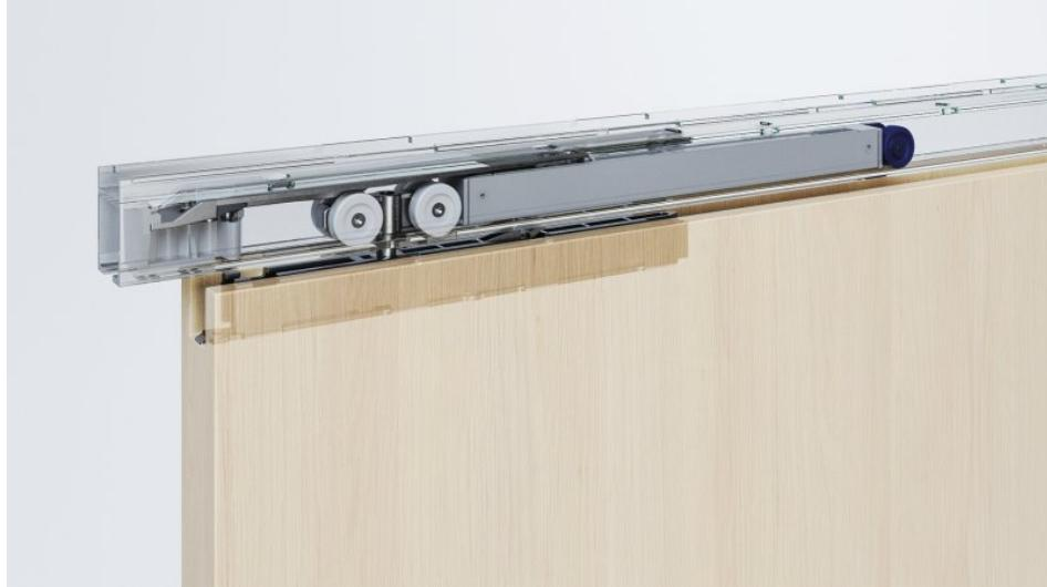
Der neue Schiebetür-Beschlag bietet auch Push-to-open-Bedienung mit Selbsteinzug (Bild: Hawa).
