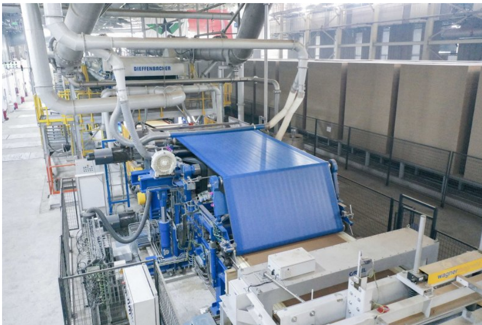
Formstrang und Vorpresse der Spanplattenanlage (Bild: Dieffenbacher).
