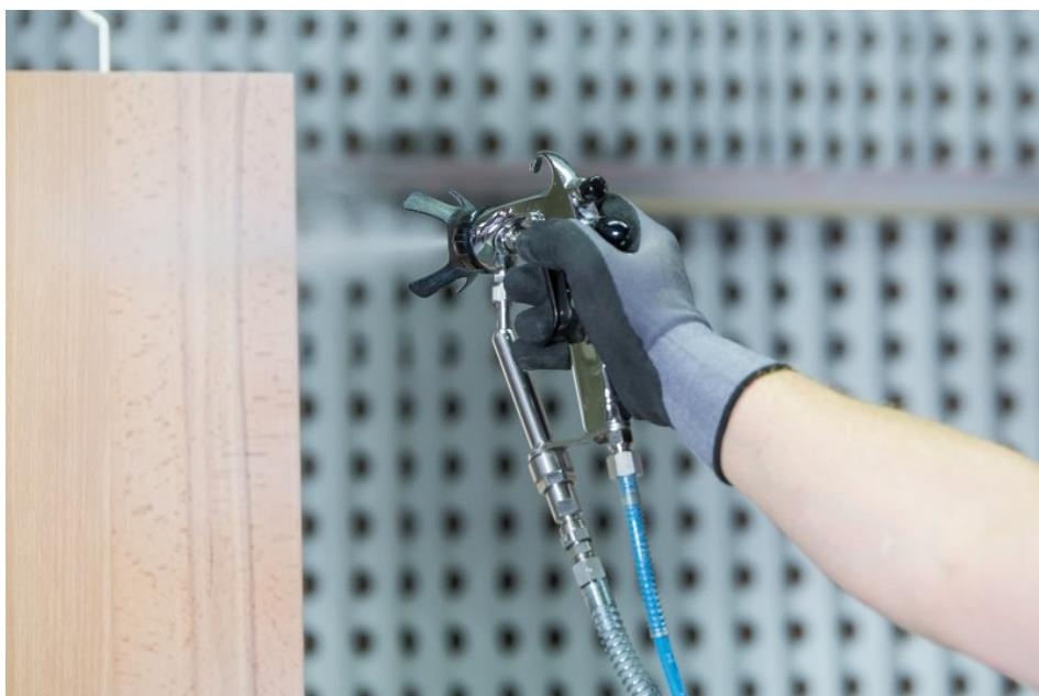
Das Produktprogramm beinhaltet auch Lösungen für die wirtschaftliche Lackierung hängender Treppenbauteile (Bild: Remmers).
