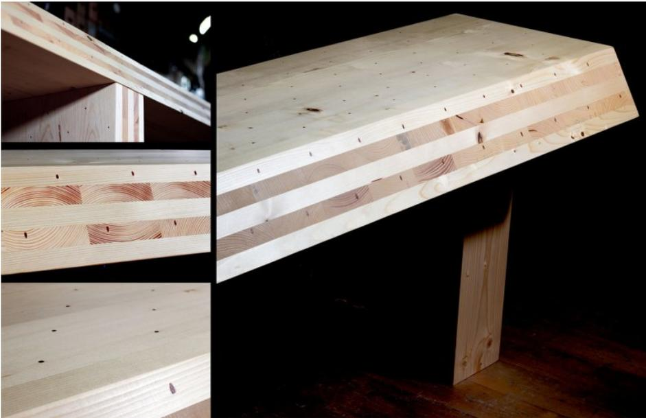
Bild des Massivholztisches mit sichtbaren Holznägeln, die Aluminiumnägeln und Holzdübeln ersetzt (Bild: Beck).
