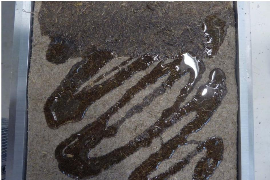
Das Nassvlies aus gereinigten Gärresten wird mit biobasiertem Harz getränkt (Bild: DITF).
