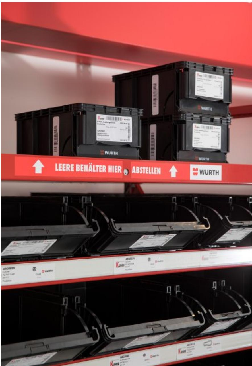
Der intelligente Regalboden sorgt für eine nahtlose Materialversorgung aus dem Kanban-Lager (Bild: Würth).
