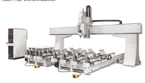
Das Hochleistungs-CNC-Bearbeitungszentrum mit zwei Tischen und programmierbarer Positionierung der Sauger (Bild: Pade).
