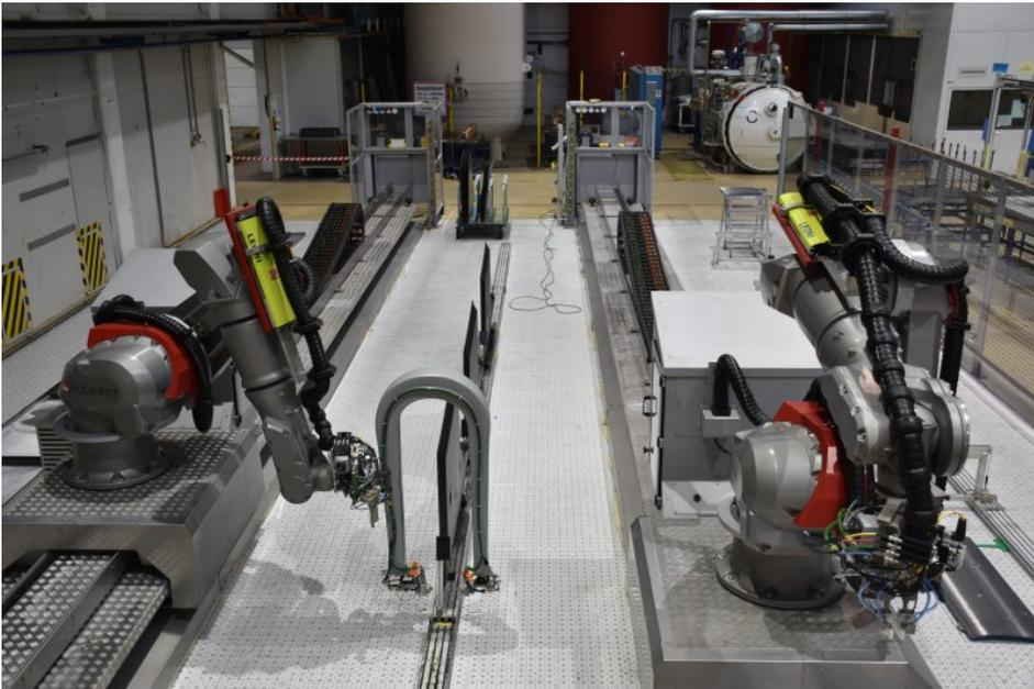
Neben der Ultraschallprüfung können die Roboter auch andere Mess- und Prüfverfahren durchführen (Bild: Fill).
