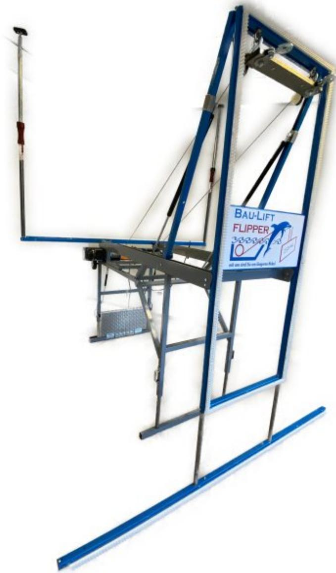
Der Baulift wurde technisch verbessert und kann jetzt max. 250 kg tragen (Bild: Richter Baulifte).
