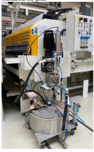
Die modernen Doppelmembranpumpen sorgen in der Holzverarbeitung bei Egger für hochwertige Beschichtungen (Bild: Timmer).
