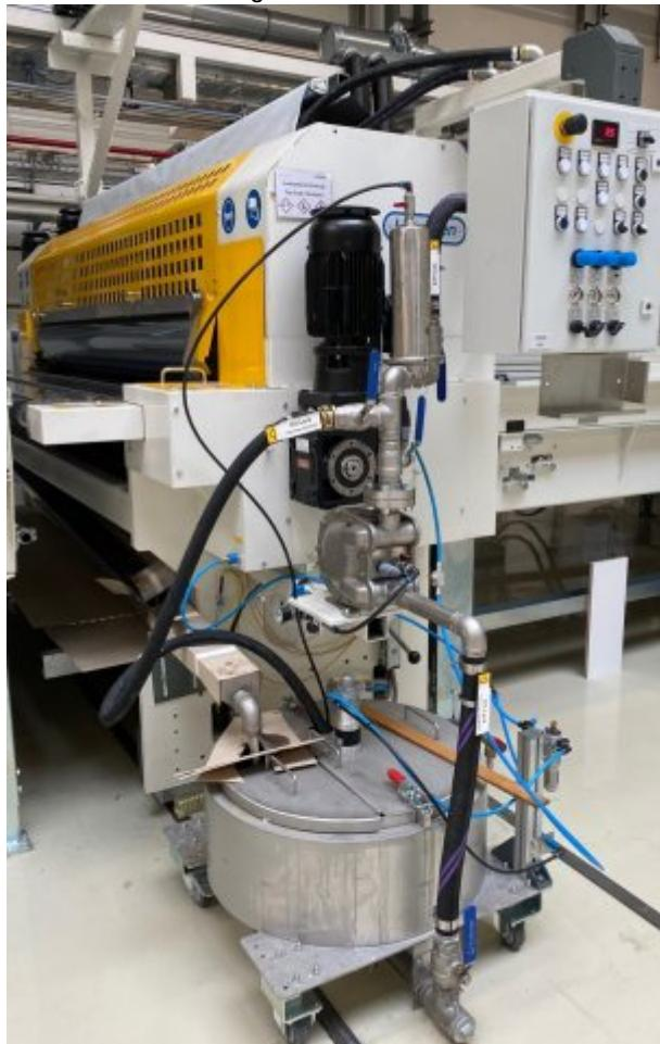
Die modernen Doppelmembranpumpen sorgen in der Holzverarbeitung bei Egger für hochwertige Beschichtungen (Bild: Timmer).
