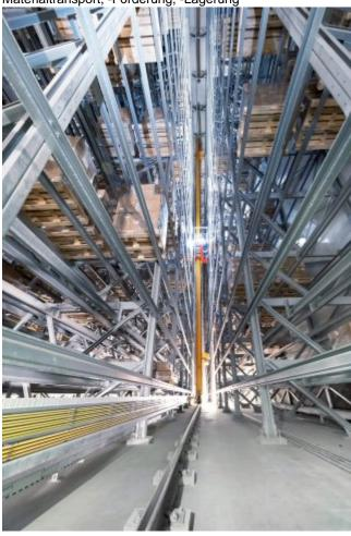
Acht Regalbediengeräte sorgen im Hochregallager für die automatische Ein- und Auslagerung von Paletten (Bild: Dematic).
