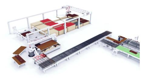
Ein Roboter übernimmt das Teilehandling, wodurch sich das Bedienpersonal anderen Aufgaben widmen kann (Bild: IMA Schelling).
