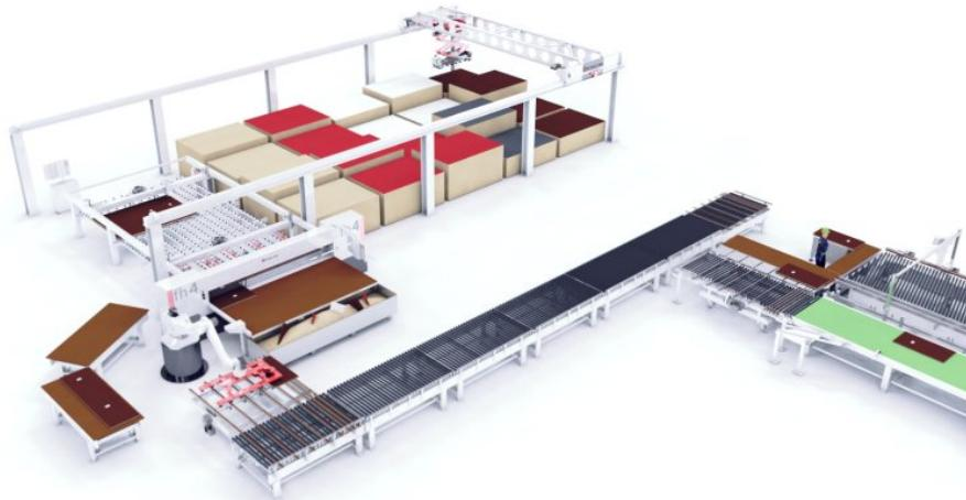
Ein Roboter übernimmt das Teilehandling, wodurch sich das Bedienpersonal anderen Aufgaben widmen kann (Bild: IMA Schelling).
