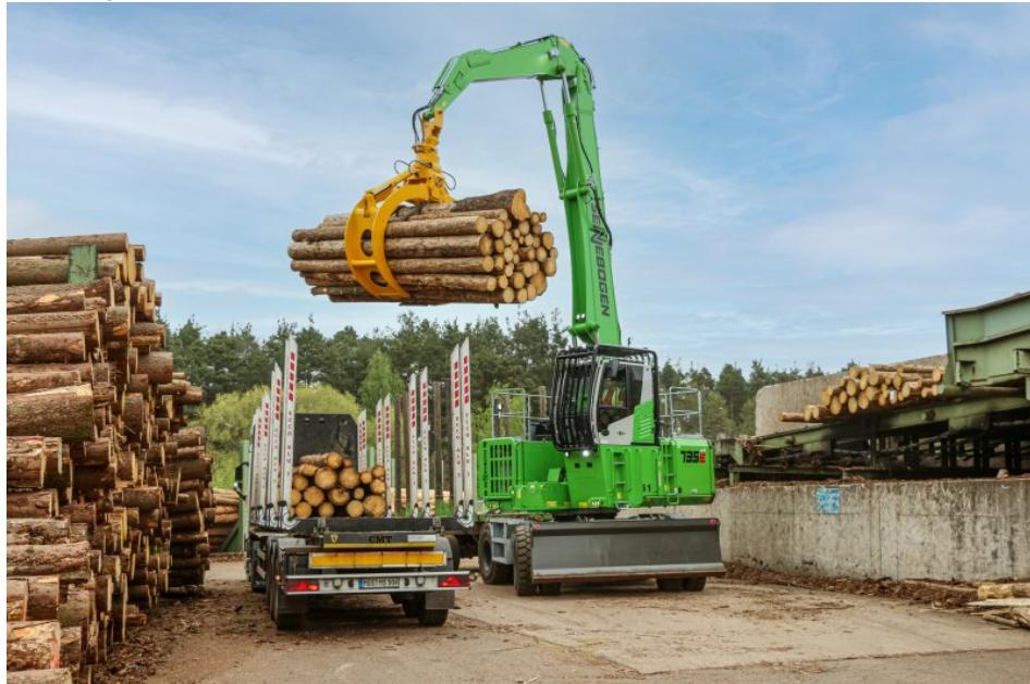
Umschlagbagger mit Holzgreifer inklusive integrierter Flyerkette beim Entladen eines Lkw-Trailers (Bild: Sennebogen).
