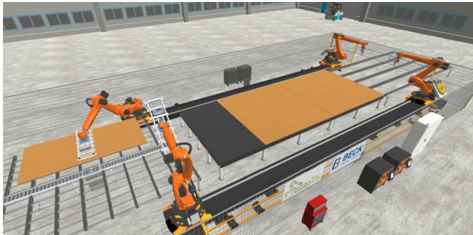
Kommissionierroboter legen die Bretter positionsgenau zu Komplettlagen, Setzroboter schießen die Holznägel lagenweise ein (Bild: Beck).
