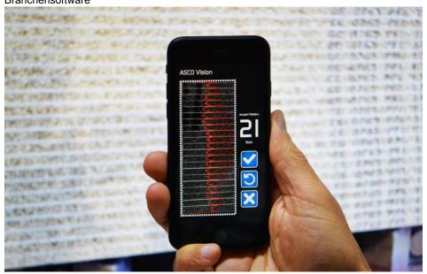
Per Kamera und Software kann die Anzahl an Platten auf einem Stapel vollautomatisch ermittelt werden (Bild: Schlipf).
