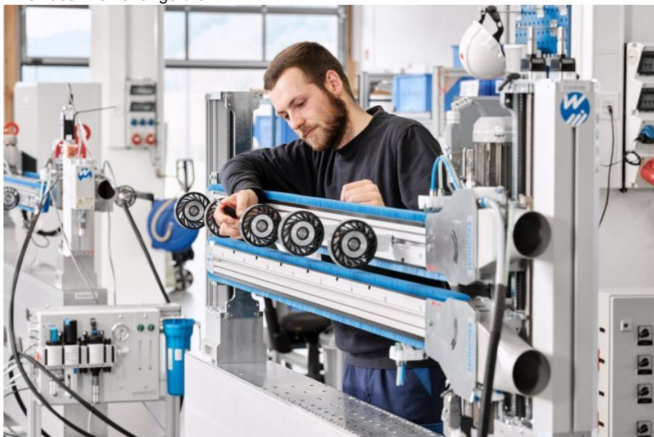
Kombi-Schwertbürsten lassen sich aufgrund ihrer kompakten Bauweise leicht in die Fertigungslinien integrieren (Bild: Wandres).
