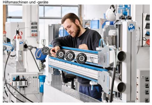
Kombi-Schwertbürsten lassen sich aufgrund ihrer kompakten Bauweise leicht in die Fertigungslinien integrieren (Bild: Wandres).
