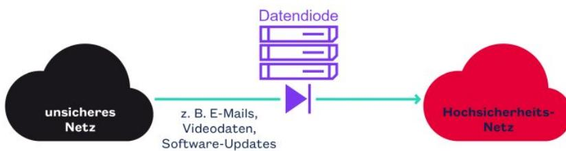
Datentransfers vom schwarzen ins rote Netz mit der neuen Datendiode (Bild: genua).
