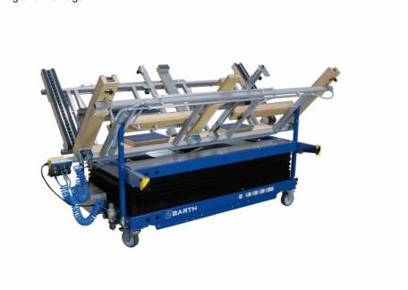
Mit der Wendefunktion können Werkstücke bis zu einem Gewicht von 140 kg und 130 cm Breite gewendet werden (Bild: Barth).
