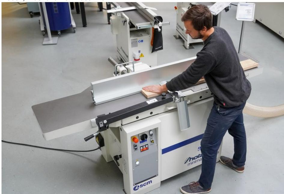
Die kombinierte Abricht-Dickenhobelmaschine ermöglicht besonders sparsames Hobeln
