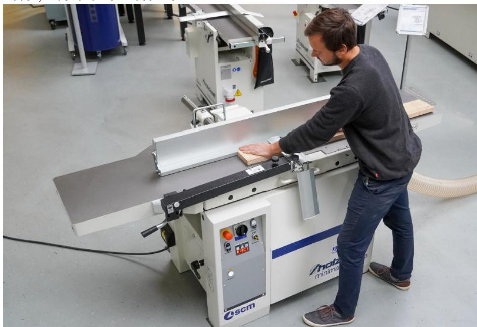
Die kombinierte Abricht-Dickenhobelmaschine ermöglicht besonders sparsames Hobeln (Bild: Stürmer Maschinen).
