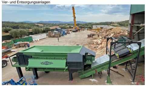
Die Zerkleinerungsanlagen ermöglichen eine vielseitige und effiziente Holzaufbereitung (Bild: Zeno).
