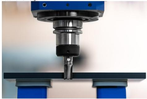
Speziell auf die Bearbeitung von HPL-Schichtwerkstoffen abgestimmte Werkzeuge erhöhen die Produktivität (Bild: JSO).
