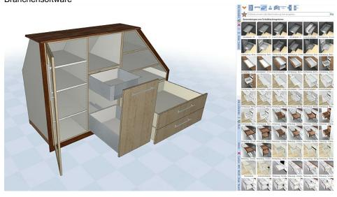
Die CAD-Software ermöglicht die einfache Konstruktion von Möbeln per Drag-and-drop (Bild: Tibek CNC-Technik).
