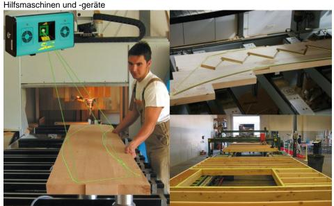
Die Laser dienen als Rüsthilfe für CNC-Oberfräsen und können auch in den Bereichen Holzrahmenbau, Nagelbinder und Leimbinder eingesetzt werden (Bild: SL-Laser).
