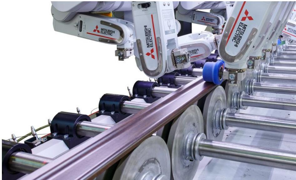
Die vollautomatische Profilummantelungsanlage arbeitet mit Knickarmrobotern von Mitsubishi (Bild: Düspohl).
