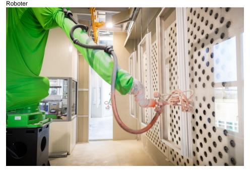
Beispielhafte Installation eines Lackierroboters mit 3D-Erkennung (Bild: Range + Heine).
