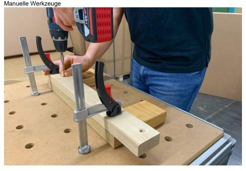
Das leichte Spannelement lässt sich werkzeuglos in die 20er-Bohrung von Multifunktionstischen integrieren (Bild: Bessey).
