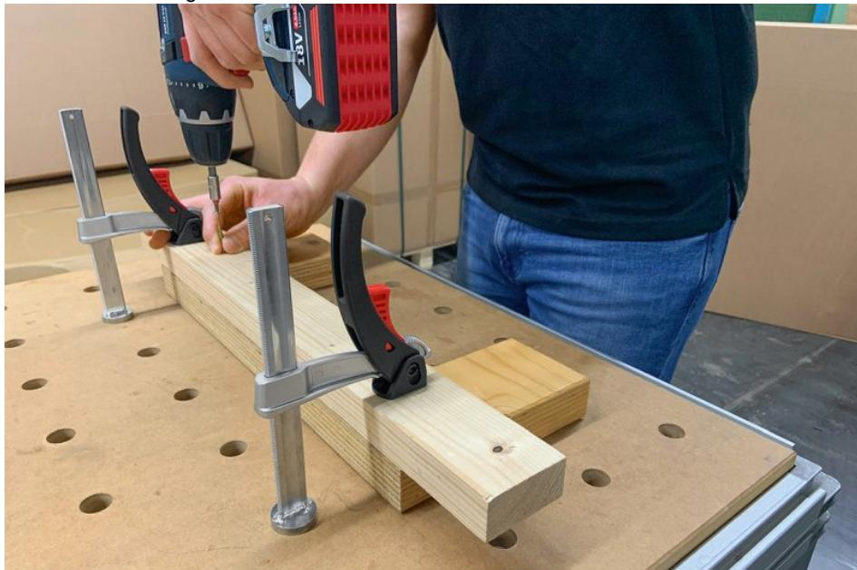
Das leichte Spannelement lässt sich werkzeuglos in die 20er-Bohrung von Multifunktionstischen integrieren (Bild: Bessey).
