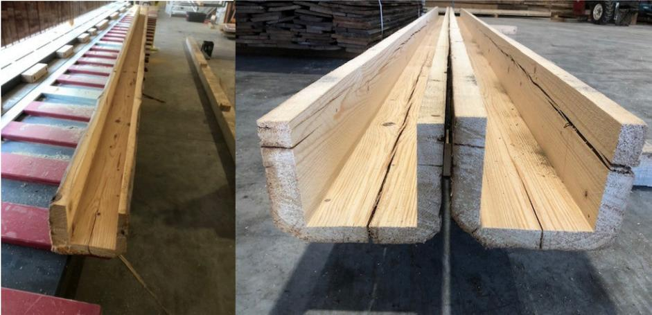
Die u-förmig ausgehöhlten Balken werden von der Längskreissäge automatisch ohne manuelle Eingriffe hergestellt (Bild: Stoll).
