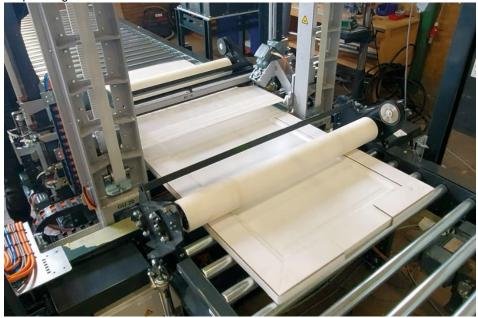
Die neue Verpackungslinie verpackt und versiegelt Türen in einem Arbeitsschritt mit Stretchfolie (Bild: Tentoma).
