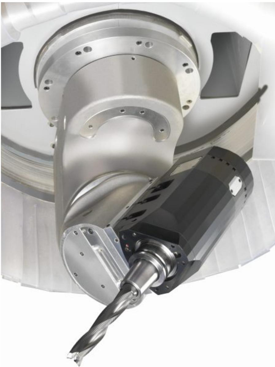
Mit 12 oder optional 15 Kilowatt Leistung sorgt die Spindel für schnelle und qualitativ hochwertige Ergebnisse beim Fräsen, Bohren und Sägen (Bild: Felder).
