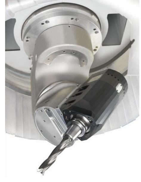
Mit 12 oder optional 15 Kilowatt Leistung sorgt die Spindel für schnelle und qualitativ hochwertige Ergebnisse beim Fräsen, Bohren und Sägen (Bild: Felder).
