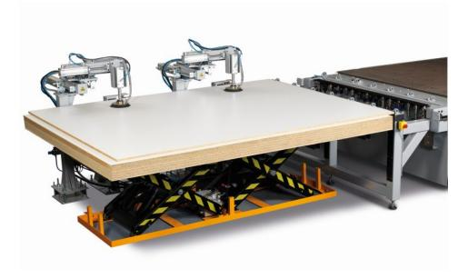
Bei der automatischen Beladung positioniert der Hubtisch den Plattenstapel direkt auf die passende Arbeitsfeldhöhe (Bild: Felder).
