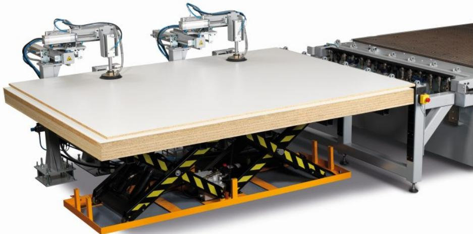
Bei der automatischen Beladung positioniert der Hubtisch den Plattenstapel direkt auf die passende Arbeitsfeldhöhe (Bild: Felder).
