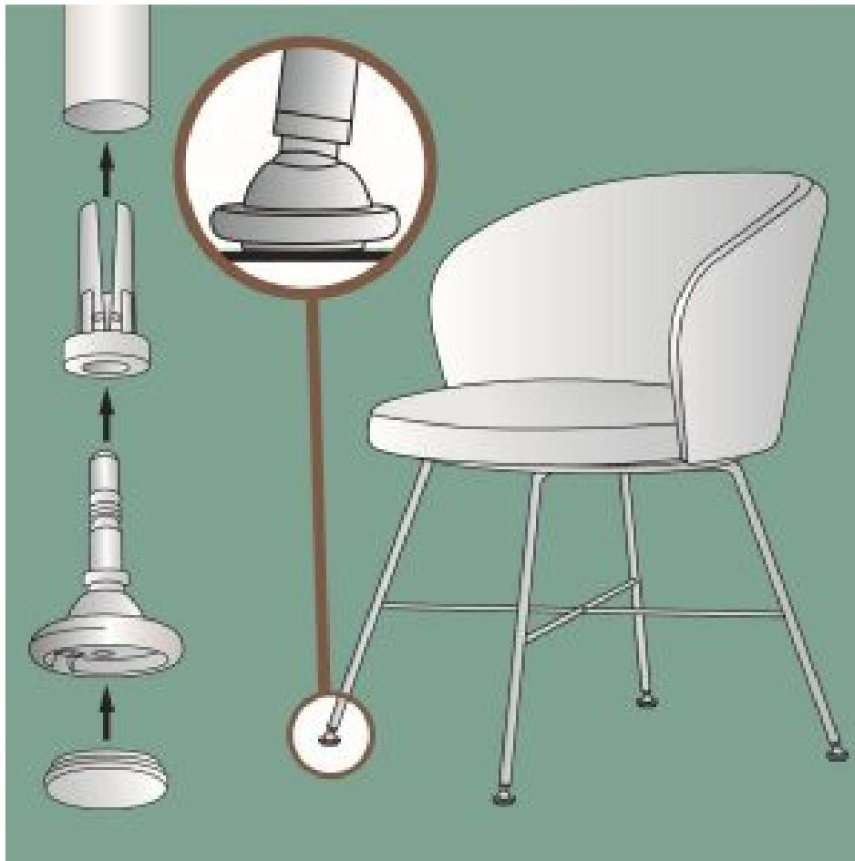
Die »QuickClick«-Basis »Ringdesign« wurde speziell für Stuhlbeine mit großem Neigungswinkel entwickelt. Die Lösung ist durch tauschbare Gleiteinsätze sehr wartungsfreundlich (Bild: Wagner).
