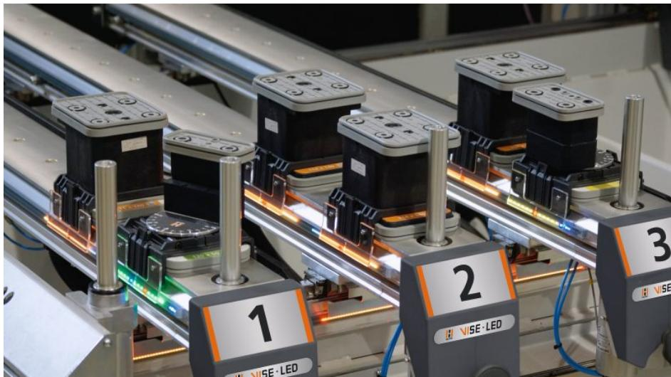
Der LED-Tisch mit Visual Setting sorgt für sehr schnelles, fehlerfreies und sicheres Rüsten – auch bei drehbaren Vakuumsaugern (Bild: Holz-Her).
